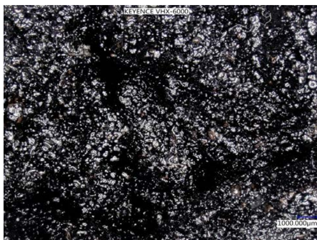
Fot. 6. Powierzchnia nawierzchni na bazie granulatu w ujęciu mikroskopowym z ® Asfix Alfa
