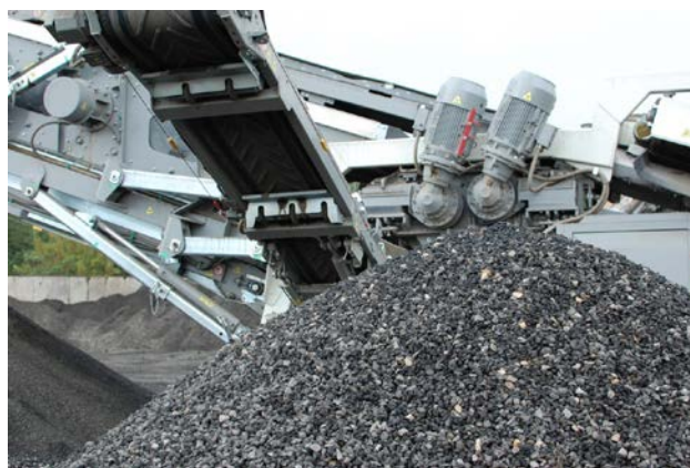
Fot. 2. Granulat asfaltowy o odpowiednio dobranych frakcjach 0/16 i 0/8
