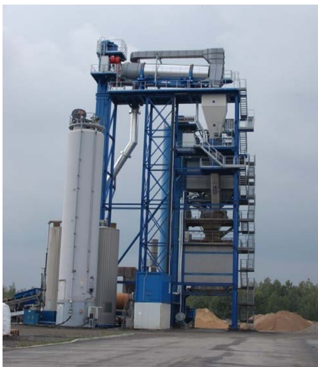
Fot. 1. Wytwórnia MMA z podwójnym bębnem o technologicznych dużych możliwościach wykorzystywania destruktu [7]
